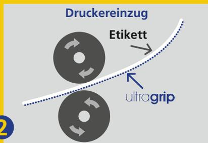
Durch diese Angriffsfläche können die Druckerwalzen den Bogen noch besser greifen, einziehen und führen.
